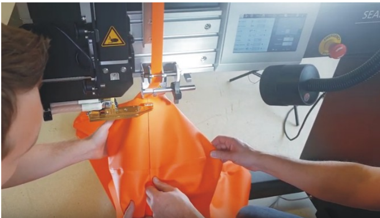
Zgrzewanie taśmy przy użyciu automatycznego podajnika zgrzewarki SEAMTEK 900AT
