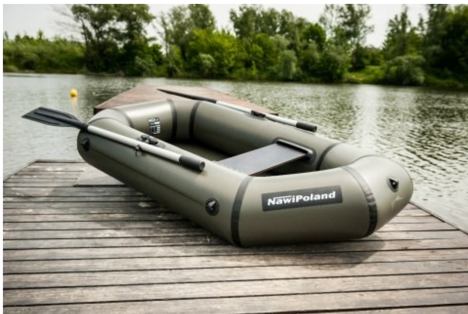
Ponton jednoosobowy wiosłowy z PVC z ławką ze sklejki wodoodpornej
