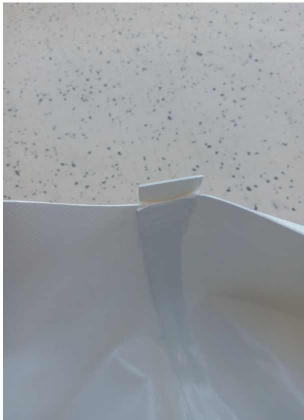
Po lewej: Zgrzew boczny dwóch segmentów burty. Po prawej: Taśma wzmacniająca 25mm zgrzana po obu stronach rozkroju.
