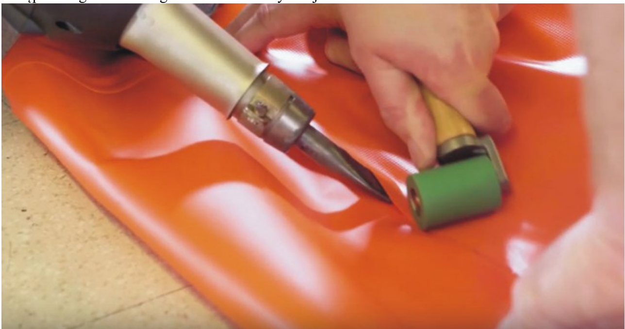
Zgrzewanie przy użyciu zgrzewarki ręcznej.
