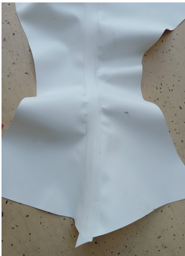
Po lewej: Zgrzew boczny dwóch segmentów burty. Po prawej: Taśma wzmacniająca 25mm zgrzana po obu stronach rozkroju.
